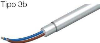
Manguito anular, cables de conexión de PTFE, sellado con resina epoxi, protegido contra la humedad, máx. 250 °C / 482 °F, Certific. UL: máx. 130 °C / 266 °F
