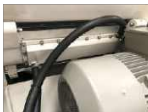
Detail: water cooling system of cutting chamber GV 360/750 Particolare: camera di granulazione raffreddata ad acqua GV 360/750
