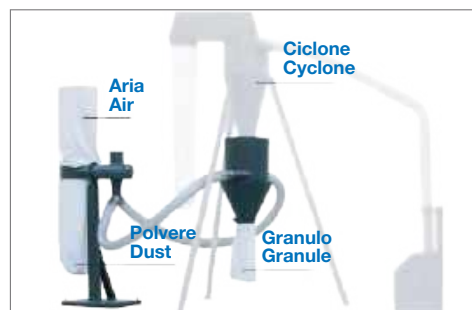
Dust separator Separatore di polvere
