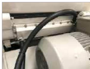
Detail: water cooling system of cutting chamber GV 300/480 Particolare: camera di granulazione raffreddata ad acqua GV 300/480
