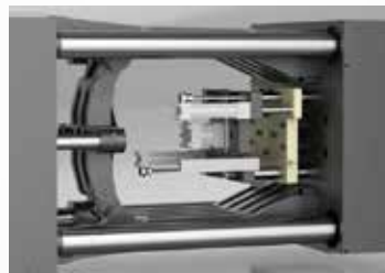
EXTRACCIÓN especial de las preformas PET
