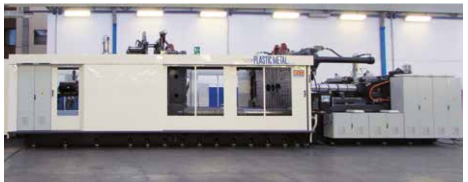
Sistema Multipower DUO H 1800 a 6 unidades de inyección
