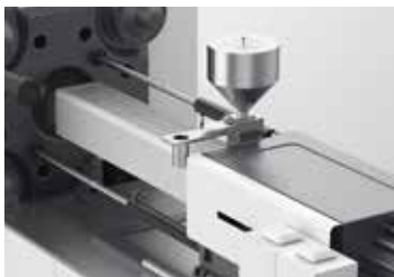
CARRERA y acercamiento inyector
