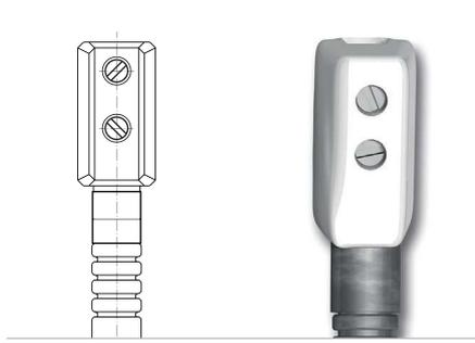
Conector de terminal cerámico 'plug 'n' heat'
