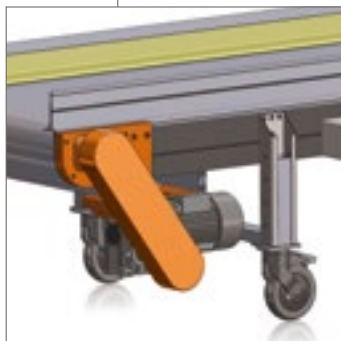
Option: Motor placed under conveyor Alternativa: Motore sotto nastro con rinvio a catena
